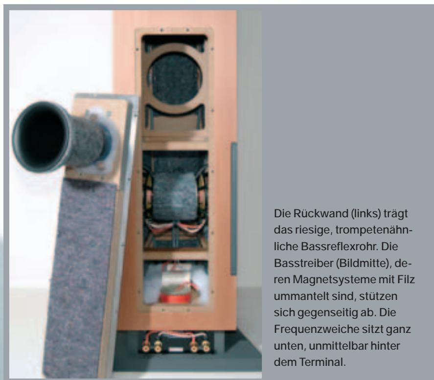
Die Rückwand (links) trägt das riesige, trompetenähnliche Bassreflexrohr. Die Basstreiber (Bildmitte), deren Magnetsysteme mit Filz ummantelt sind, stützen sich gegenseitig ab. Die Frequenzweiche sitzt ganz unten, unmittelbar hinter dem Terminal.
