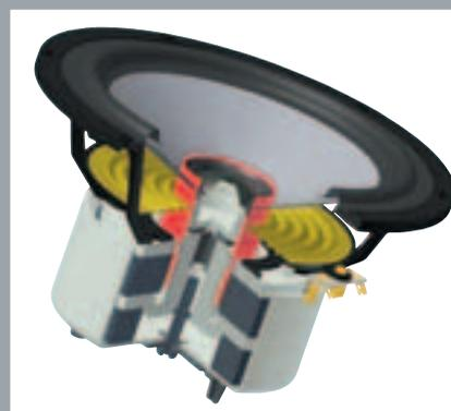
Der Koax (oben) und sein Aufbau: An zentraler Stelle im Schwingsystem des Mitteltöners (rot markiert) ist eine Hochtonkalotte mit Neodymmagnet montiert. Das Abstrahlverhalten ist dadurch vertikal und horizontal absolut gleich.
