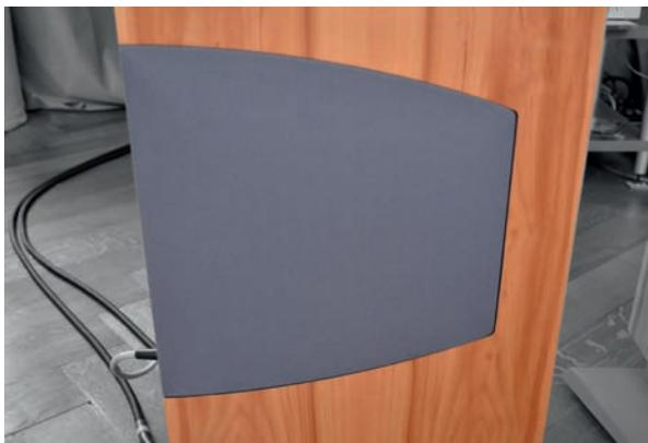
einem Bassreflex-Gehäuse wählen, bei der aktiven nicht. Zum einen benötigt nämlich die Verstärkerelektronik – zwei Endstufen á 180 Watt kommen pro Box zum Einsatz – ihren Platz, und den nimmt sie dem Bassreflexkanal weg; zum anderen: Wozu sollte das auch gut sein? Der Pegelgewinn im Frequenzuntergeschoss durch ein Bassreflexgehäuse lässt sich aktiv geregelt doch auch erreichen, ja, bei der Aktiv-Avancé geht's sogar, wenn man will, bis 20 Hz hinunter.
