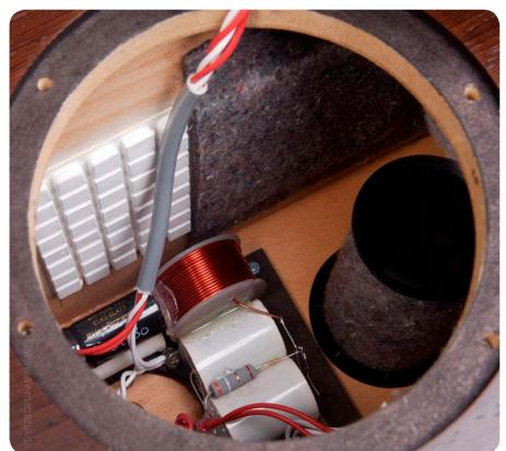
Nach Entfernen des Dämmungsmaterials erkennt man die in weissen Matten aufgebrachten Stahlkugelmatten, die für die wirksame Schwingungsunterdrückung des Gehäuses sorgen
